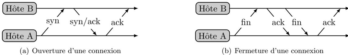
FIGURE A.1 – Ouverture et fermeture d'une connexion
